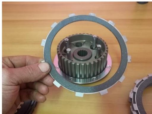
**Inserire successivamente il disco bombato (la punta verso il motore). Oltre che per la bombatura, il disco bombato è riconoscibile perché ha stampato una lettera "B" o una "G" o un piccolo punto in mezzo a un dente.**
