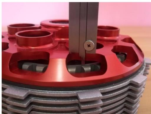
**Per un corretto funzionamento della frizione bisogna rispettare assolutamente le misure qui di seguito riportate. Come si può vedere dall'immagine qui sopra si effettua la misurazione mediante l'asta di profondità del calibro, appoggiando il calibro dallo spingidisco fino a toccare il tamburo della frizione. La misura così ottenuta deve essere compresa tra le due qui sotto indicate.**
