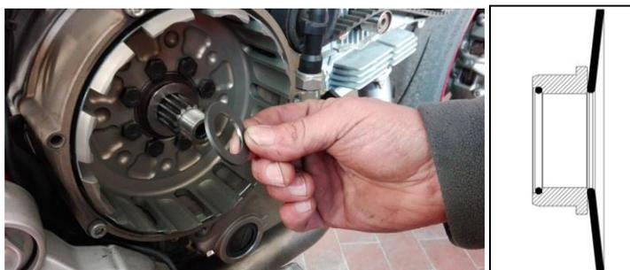
Con del grasso lubrificare le guide delle sfere sul castelletto frizione e inserire le sfere.
